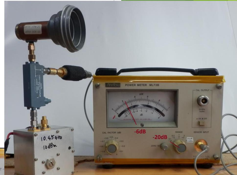
方向性結合器に50ΩATTを接続して、方向性 (Directivity) が30dB以上取れていることを確認後に10GHzコルゲートホーンを接続。パワーメータレンジ-20dBにさらに-6dB
